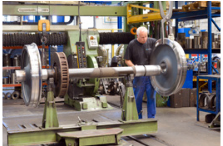
Maintenance des essieux
